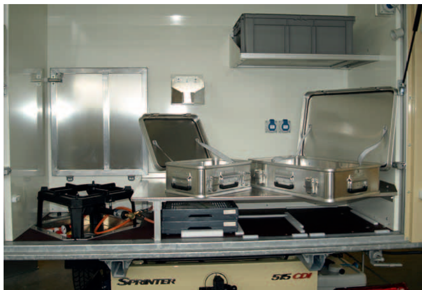
Abb. 3: Zur Benutzung des Hockerkochers (l.) wird die Arbeitsplatte aufgeklappt. Die Alu-Transportkisten bieten genügend Raum für Kleinkram, auf den man schnell Zugriff haben möchte
