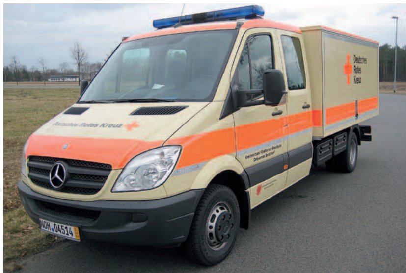
Abb. 1: Front- und Seitenansicht GW-Betreuung: Sonder-signalanlage und Beklebung sind durch das DRK zur Minimierung der Kosten in Eigenarbeit angebracht worden
