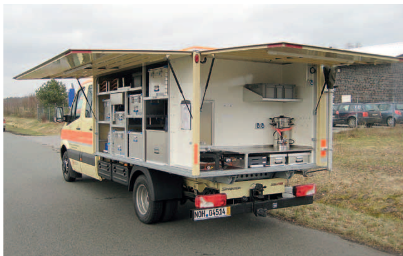
Abb. 2: Heck-/Seitenansicht: Der Arbeitsbereich des Teeküchenmoduls wird durch die hochgestellte Heckklappe vor Witterungseinflüssen geschützt
