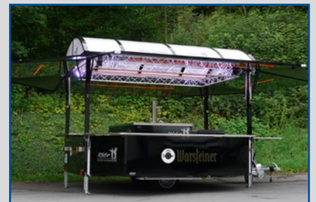
Kuppeldach und Traversenkonstruktion mit LED-Beleuchtungssystem
