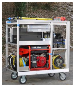
Schwere Ausrüstungsgegenstände wie Stromerzeuger sind auf den Rollwagen verlastet.
