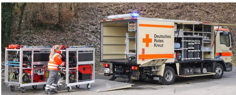
Die 4 Rollwagen werden über die LBW mühelos auf- und abgeladen.
