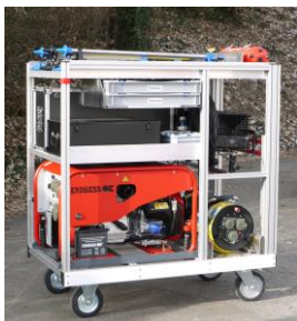
Schwere Ausrüstungsgegenstände wie Stromerzeuger sind auf den Rollwagen verlastet.
