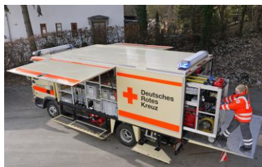
Die 4 Rollwagen werden über die LBW mühelos auf- und abgeladen.
