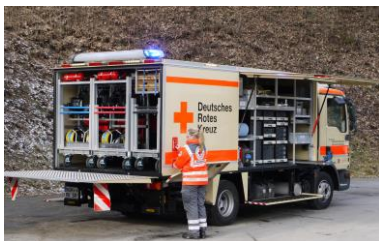
Die 4 Rollwagen werden über die LBW mühelos auf- und abgeladen.
