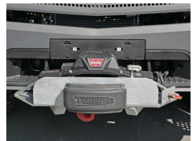
Seilwinde gem. Förderrichtlinie: WARN ZEON 10, Zugkraft 4.536 kg Seillänge: 24,3 m x 9,52 mm
