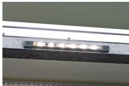
Seitliche Umfeldbeleuchtung: pro Seite je 2 LED-Umfeldleuchten bei geöffneter Seitenwand am seitlichen inneren Dachrahmen oben außen, nach außen leuchtend
