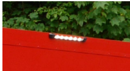
Seitliche Umfeldbeleuchtung: pro Seite je 2 LED-Umfeldleuchten bei geschlossener Seitenwand an der seitlichen Dachkante der Seitenoberwand
