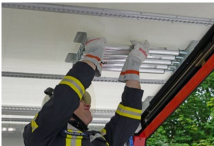
Querabsperrungen, unter dem Aufbaudach verlastet
