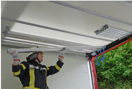
Senkrechte Teleskopabsperrstangen unter dem Aufbaudach verlastet
