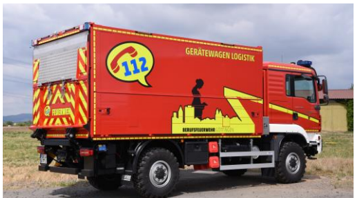
Aufbau mit geteilter Ladebordwand für Einsatz als Schlauchwagen (Fotos s.o.)
