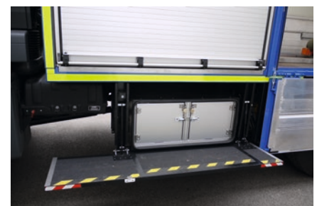
Auftritt und dritter Aufbauraum für Sprengstoff
