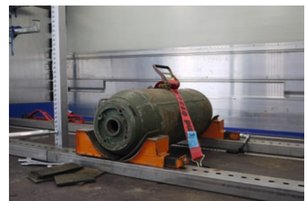
Ladungssicherung auf einsteckbaren Schienen
