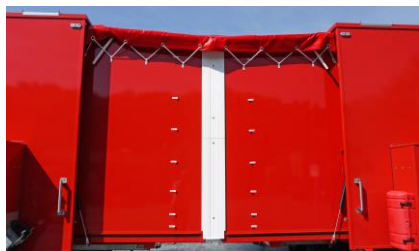
Anhänger-Kopplung: Dachverbindungsplane und Übergangslleiste
