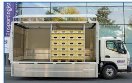
Ladegutsicherungsmaßnahmen nach VDI 2700 Blatt 12 für Teilbeladung durch System Allsafe JUNGFALK Typ TRS vierreihig. Vordere Absperrwand zur Vorderachsentlastung. Mögliche Gesamtnutzlast verteilt auf 4 bis 10 Palettenstellplätze ohne Achsüberladung nach Lastverteilplan.
